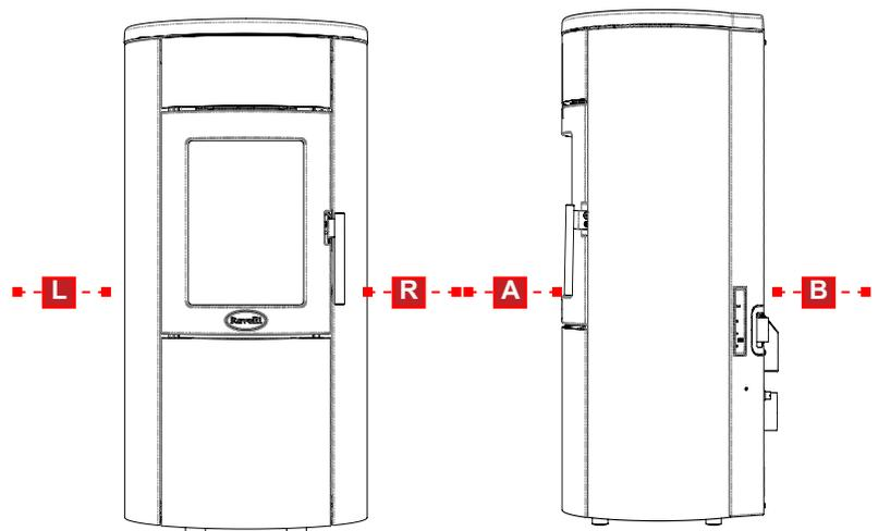
Se il pavimento su cui è appoggiata la stufa è di materiale infiammabile si consiglia un adeguato isolamento. Non possono essere immagazzinati oggetti e parti sensibili al calore o infiammabili in prossimità della stufa.
