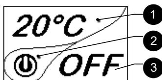
**i** Dopo 5 minuti di inattività, il display del palmare si oscura passando in modalità "SLEEP", pur mantenendo la connessione radio con la stufa. Una successiva pressione del tasto ON/OFF riattiva il display.
