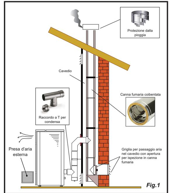
All'uscita della stufa non montare una curva a 90°, in quanto la cenere potrebbe ostruire in poco tempo il passaggio dei fumi, causando problemi di tiraggio della stufa (vedi Fig. 2).
