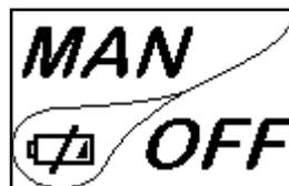
In caso di batteria scarica, all'interno della "goccia" è presente un simbolo che indica lo stato di limite della stessa, pur mantenendo attive le funzioni del palmare.
